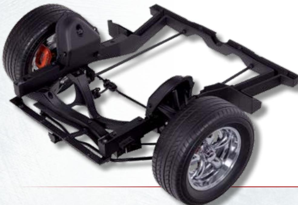
← На изображении — собранная передняя секция шасси с установленными колесами
